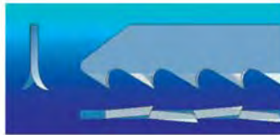
фрезерованные разведенные зубья
