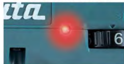
Мигает красным: Заряд батареи практически израсходован Светит красным: Заряд батареи полностью израсходован; система защиты батареи отключит инструмент
