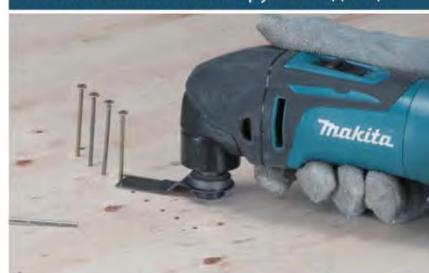
Резка гвоздей заподлицо
