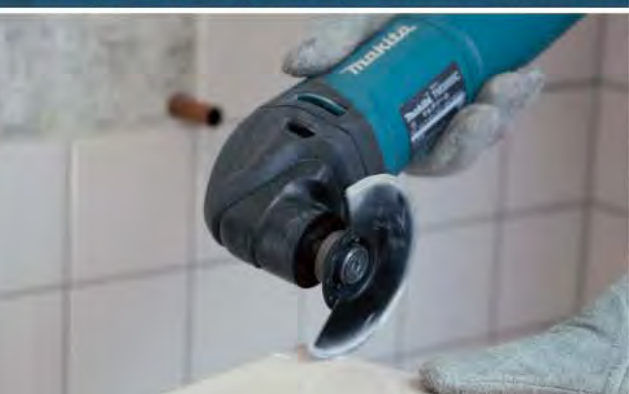
Резка керамической плитки
